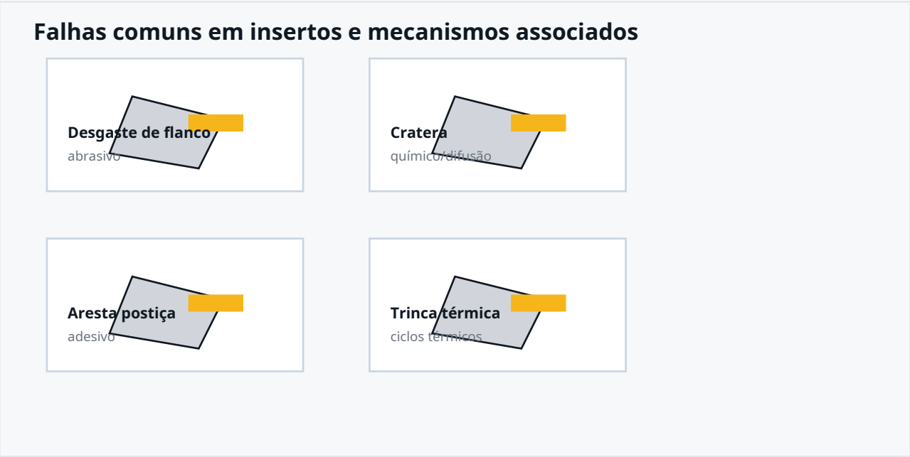
Figura 7 - Diagnóstico visual de desgaste ajuda a decidir se o problema está em velocidade, avanço, classe, geometria ou estabilidade.
